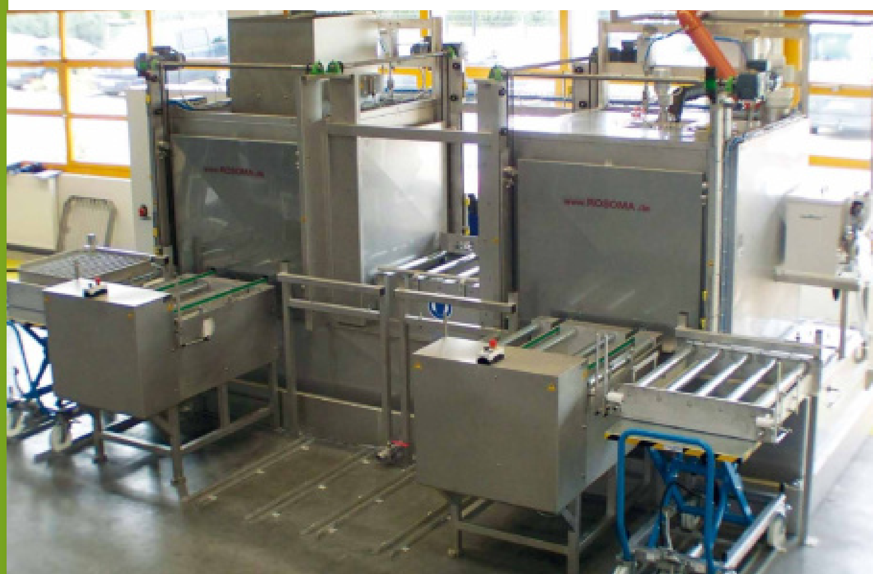
zweistufige modulare Reinigungsanlage / Fertigungstechnik Nord GmbH 2-step modular cleaning machine
